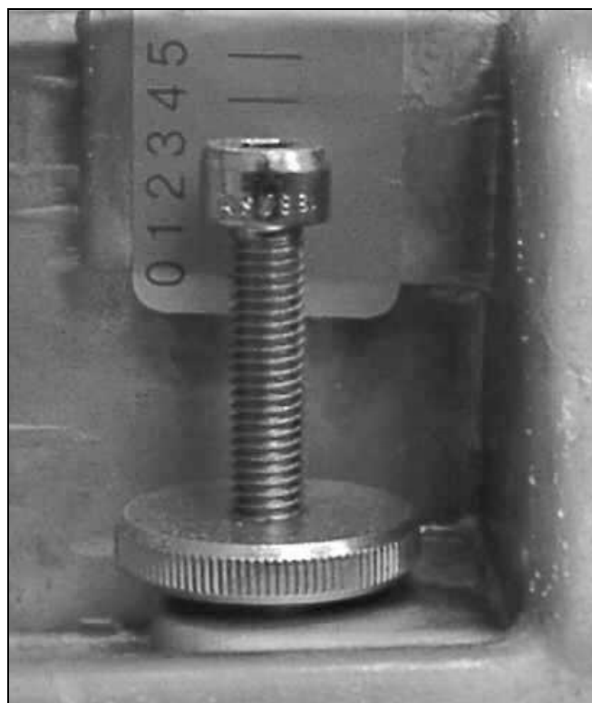
Рис. 6: Настройка воздушной заслонки
