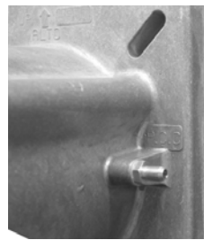
Штуцер для замера давления в камере сгорания
